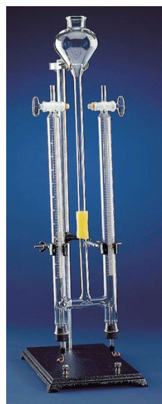
Figura 6.4. Schema electrolizei apei acidulate cu ajutorul electrolizorului Hoffman
